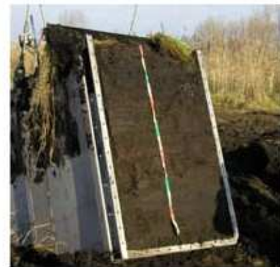
Лизиметрический сосуд после изъятия почвенного монолита в болотной местности
