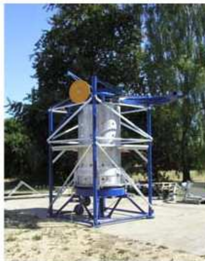
Лизиметрическое устройство извлечения почвы
