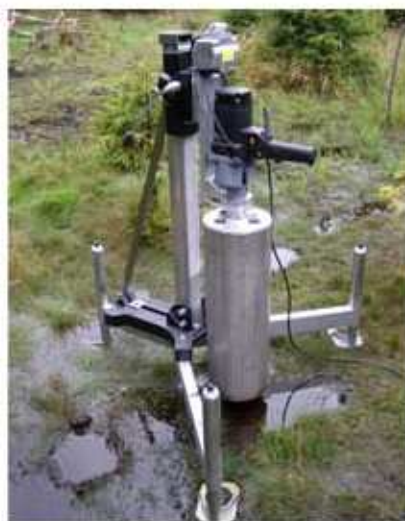
Вертикальное изъятие монолита из торфяной почвы
