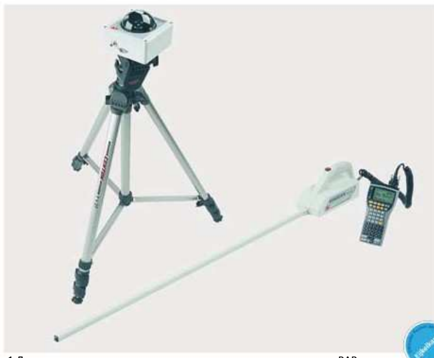
1 Датчик падения света с ручным модулем и внешним сенсором PAR на телескопическом штативе
