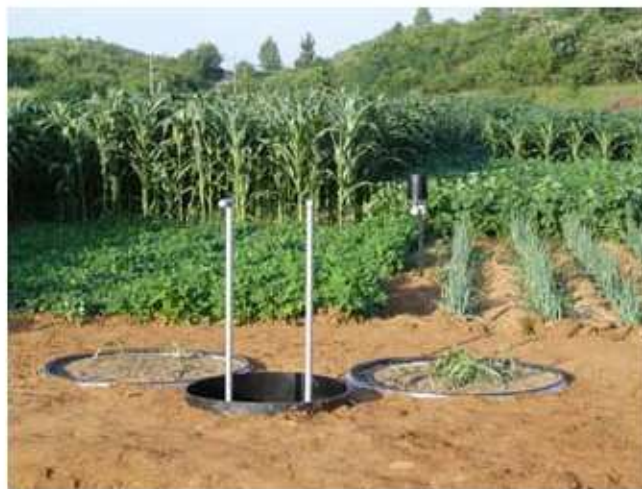
PE-HD лизиметрическая станция на 2 лизиметра во время и после установки в городе Шихия/ Китай
